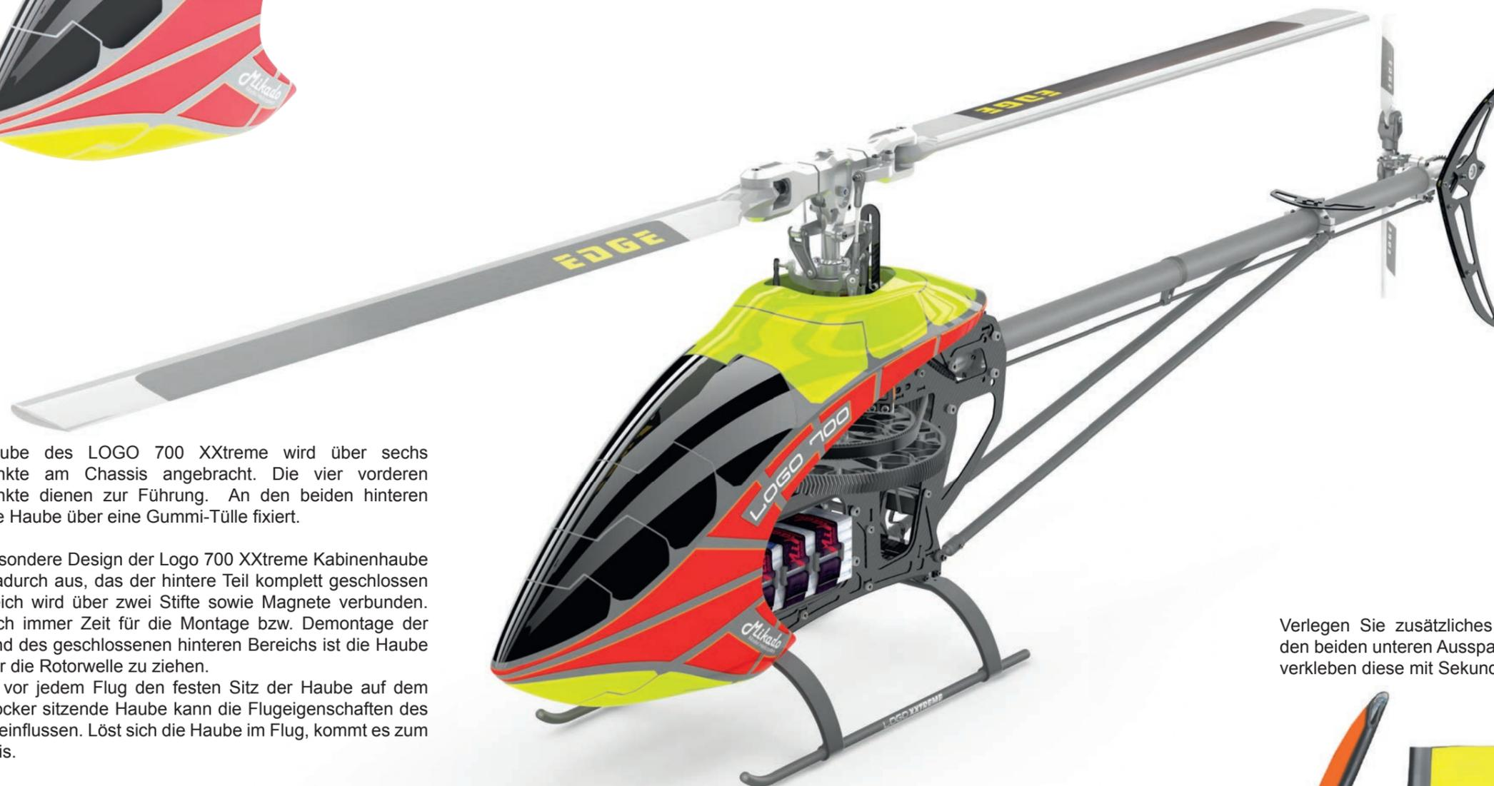
Die Kabinenhaube des LOGO 700 XXtreme wird über sechs Befestigungspunkte am Chassis angebracht. Die vier vorderen Befestigungspunkte dienen zur Führung. An den beiden hinteren Punkten wird die Haube über eine Gummi-Tülle fixiert.
