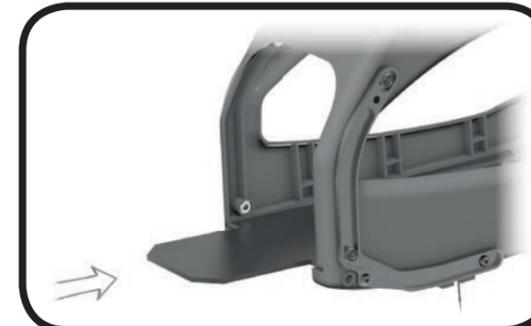
Nachdem das Chassis komplett montiert ist, schieben Sie die Akkuplatte von vorne in das Chassis.
