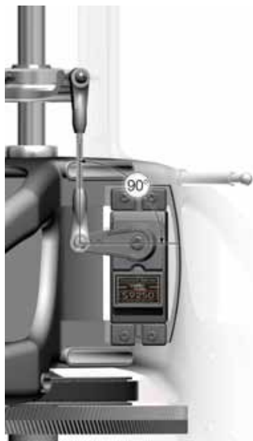
Servoarmposition bei Knüppelmittelstellung (0° Pitch) für die Rollservos
