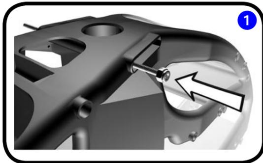
1 Mit Hilfe der Gewindestange M2,5x60 positionieren Sie alle 14 Stopmutter im rechten Seitenteil.
