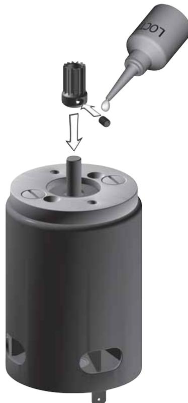
Die genaue Position für die Befestigung des Ritzels ermitteln Sie, wenn Sie das Hauptzahnrad eingebaut haben. Erst dann fixieren Sie den Gewindestift des Ritzels endgültig. Für die Befestigung des Antriebsritzels gibt es zwei Möglichkeiten:
