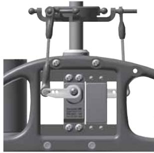
Gestängeführung bei Verwendung von breiteren Servos.
