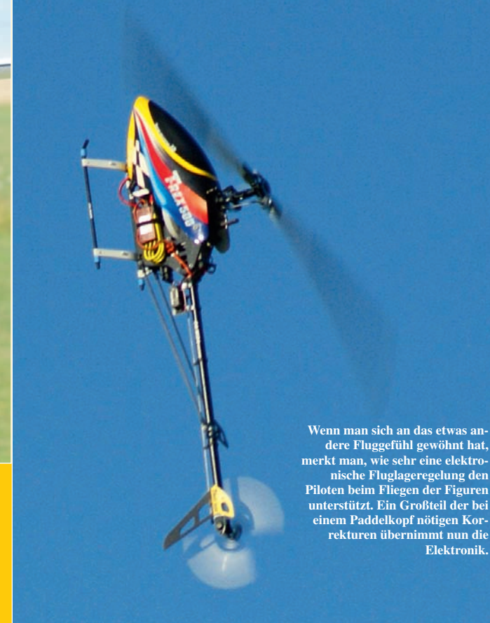
Der Rotorkopf des T-Rex 500 wurde mit dem Upgrade von Mikado auf den Einsatz des Mini-VStabi vorbereitet.
