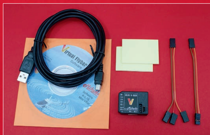
Der Lieferumfang des Mini-VStabi umfasst neben dem System selbst die Anschlusskabel für herkömmliche Empfänger, doppelseitig klebendes Dämpfungsmaterial, das USB-Anschlusskabel sowie eine deutschsprachige Anleitung und die CD mit der Konfigurations-Software und hilfreichen Videos für die Inbetriebnahme.
