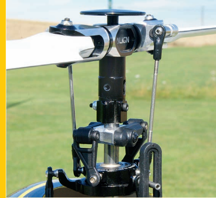
Der Rotorkopf des T-Rex 500 wurde mit dem Upgrade von Mikado auf den Einsatz des Mini-VStabi vorbereitet.
