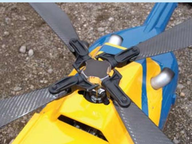
Einer der Prototypen des von Andy Rummer konstruierten Eigenbau-Vierblattrotors
