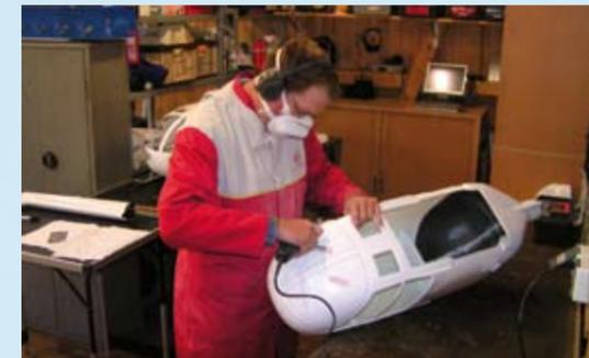
Zuerst einmal müssen alle Fenster- und Türeinausschnitte vorgenommen werden, was sich am besten mit einer hochdrehenden Kleinbohrmaschine und einem Spezialfräser bewerkstelligen lässt. Achtung: Bei solchen Arbeiten stets Staubschutzmaske tragen
