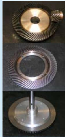
Details des Getriebes bestehend aus Stahl-Hauptzahnrad und palliodverzahnnten Kegelrädern für Haupt- und Heckantrieb
