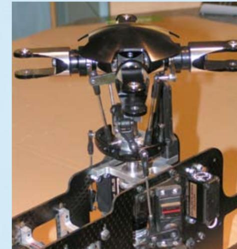
Der Hirobo-Vierblatt-Hauptrotor in Verbindung mit Mikado-Taumelscheiben-Mitnehmer und Vario-Taumelscheibe. Die BLS-Servos sind im Winkel von 120 Grad angeordnet
