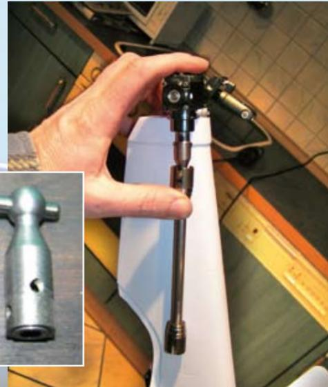
Zur kraftschlüssigen Verbindung der Antriebselemente werden Kardankupplungen verwendet
