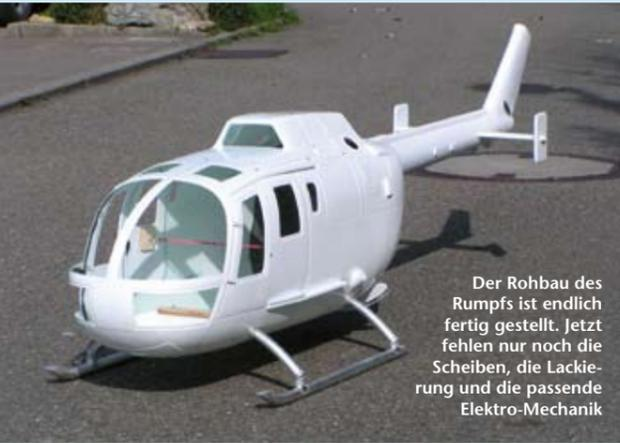
Der Rohbau des Rumpfs ist endlich fertig gestellt. Jetzt fehlen nur noch die Scheiben, die Lackierung und die passende Elektro-Mechanik
