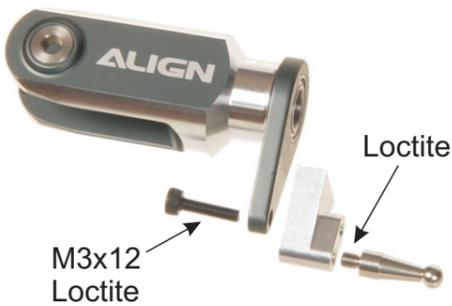
Befestigen Sie die Armverlängerung mit der Sechskantschraube 3x12.
