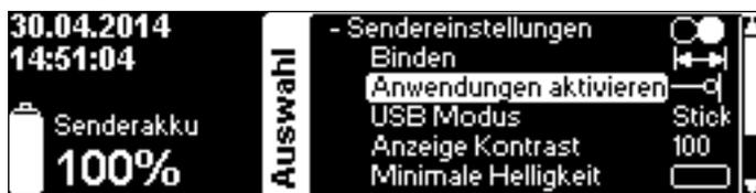
**USB Modus** dient dazu, umzuschalten zwischen **USB Stick** (Normalbetrieb/Setup/Update), **Simulator** (macht aus VBar Control einen Game Controller für Ihren Lieblingssimulator) oder **Kein USB** (Anschluss temporär deaktiviert).
