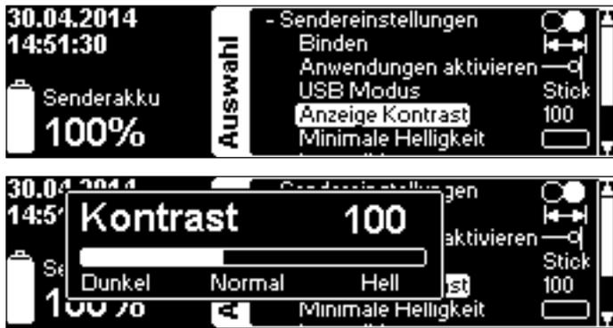
**Minimale Helligkeit** setzt den unteren Schwellenwert für den Umgebungslichtsensor. Das Display wird nie dunkler werden als hier eingestellt. Um die Akkulaufzeit zu verbessern, wählen sie den niedrigsten Wert, der für Sie in Frage kommt.
