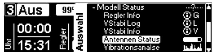
Sobald ein Empfänger verbunden ist, finden Sie im Menü **Modell Status/Antennen Status** eine grafische Anzeige zur Beurteilung der Empfangsleistung. Sie sehen Live-Balkenanzeigen für die Leistung der vier Antennen (Tx=Sender, Rx=Empfänger) sowie eine Feldstärke-Anzeige.
