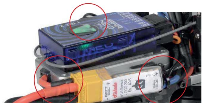
Einbau-Beispiel LOGO 200: Befestigung mit Regler-Kabel und Kabelbinder an den Motorkabeln, Durchführung des Sensor-Kabels hinter Regler/VStabi NEO, Anschluss an TELE 1 oder 2.
