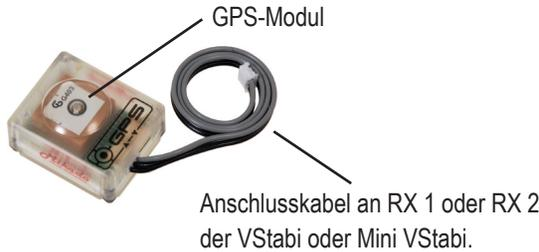
Befestigen Sie das GPS-Modul so, dass im Normalflug die Oberseite nach oben/zum Himmel zeigt.
