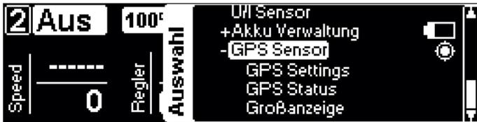
**GPS Status** zeigt alle wesentlichen Messwerte des GPS-Moduls: Geschwindigkeit, Höhe, verfügbare und verwendete Satelliten sowie die GPS-Koordinaten. Die Magnetometer-Anzeige hat derzeit keine Bedeutung.
