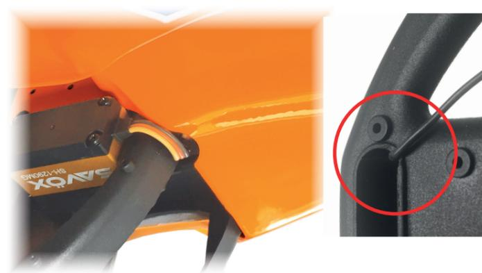
Kabel (Heckservo, ext. Gyro Sensor usw.) so verlegen dass sie nicht am Rumpf „anliegen“. Für das Antistatikkabel versehen Sie das Chassis mit einer kleinen Aussparung damit die Heckverkleidung nicht auf das Kabel drückt.
