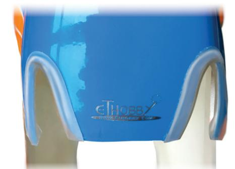
Verlegen Sie zusätzliches Kantenschutzband in den beiden unteren Aussparungen der Haube und verkleben dieses mit 5-min Epoxy.
