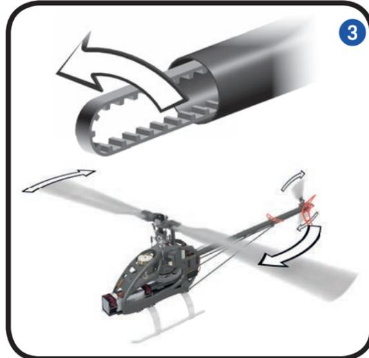
Heckrohr vorsichtig bis zum Anschlag einschieben, dabei die Aufnahme nicht beschädigen und die Schrauben endgültig festziehen.
