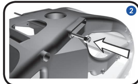
Befestigen Sie die beiden Riemenandruckrollen (#4089, Beutel 1) vor dem Zusammensetzen der Seitenteile.
