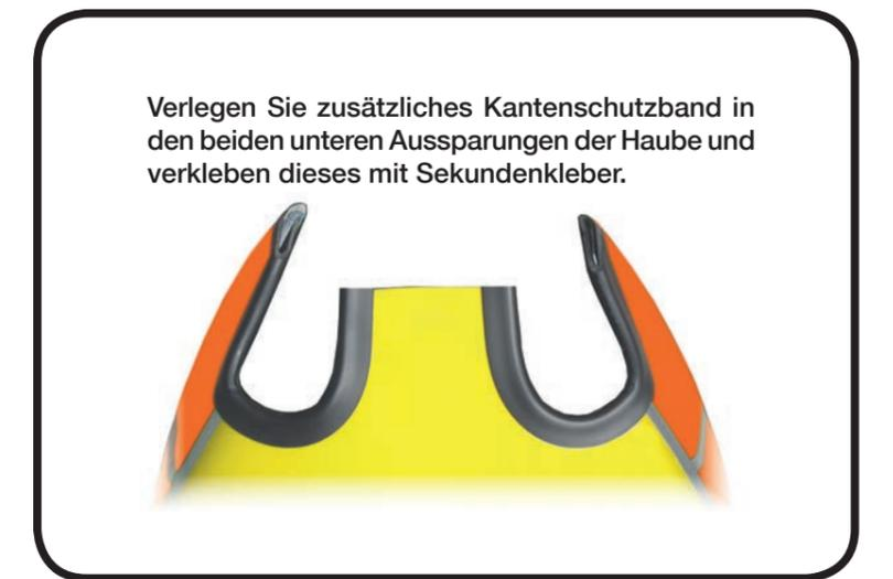
Verlegen Sie zusätzliches Kantenschutzband in den beiden unteren Aussparungen der Haube und verkleben dieses mit Sekundenkleber.
