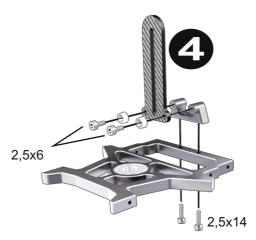
Befestigen Sie jetzt die Taumelscheibenführung an der oberen Servo Domplatte.
