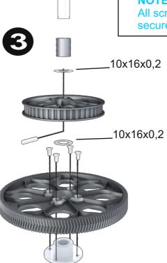
Die Rotorwelle Riemenrad, Hauptzahnrad und Freilaufnabe werden vom alten LOGO Chassis übernommen. Zusätzlich wird eine 15mm Abstandsbuchse zwischen Riemenrad und Rotorwellenlager eingebaut.
