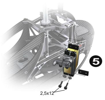
Die drei Taumelscheiben Servos werden mit 4x Sechskantschrauben 2,5x12 befestigt. Die Servos werden ohne die Distanzhülsen verschraubt. Für Futaba Servos verwenden Sie bitte die Distanzplatten (nur für die beidenRoll Servos).
