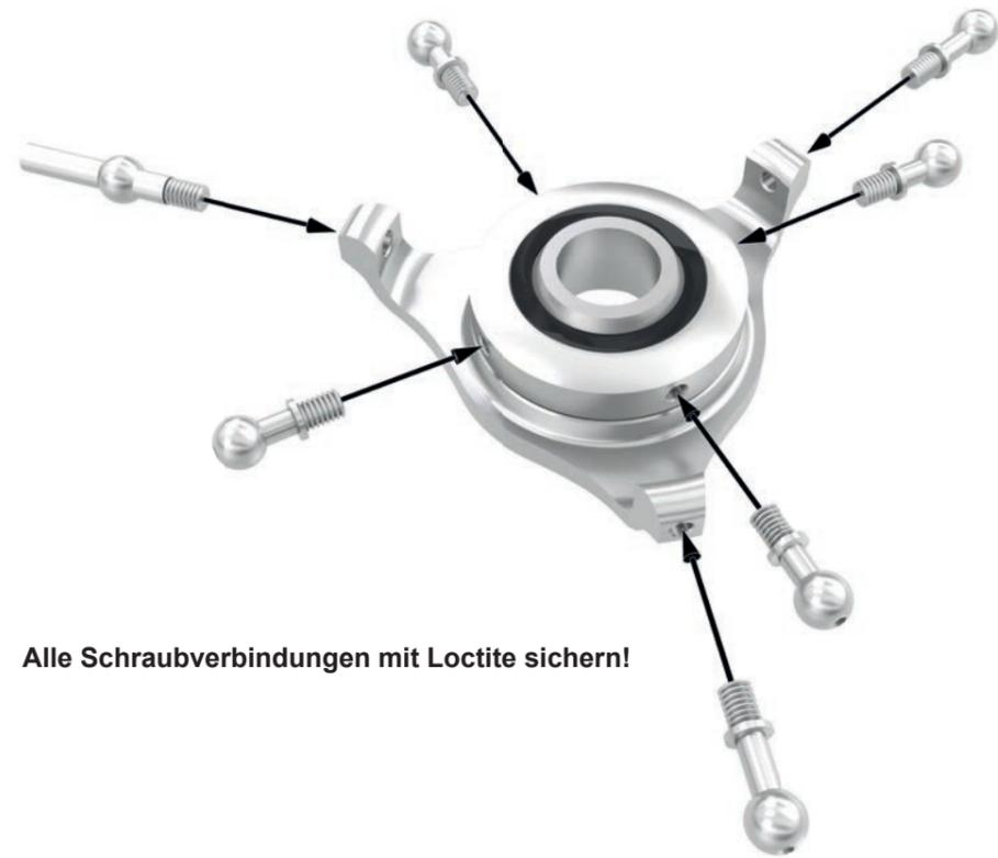
Alle Schraubverbindungen mit Loctite sichern!
