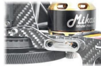
Bild 3) Das kurze Kabel an der Motorplatte befestigen und mit dem Kabel vom Heckrohr verbinden.
