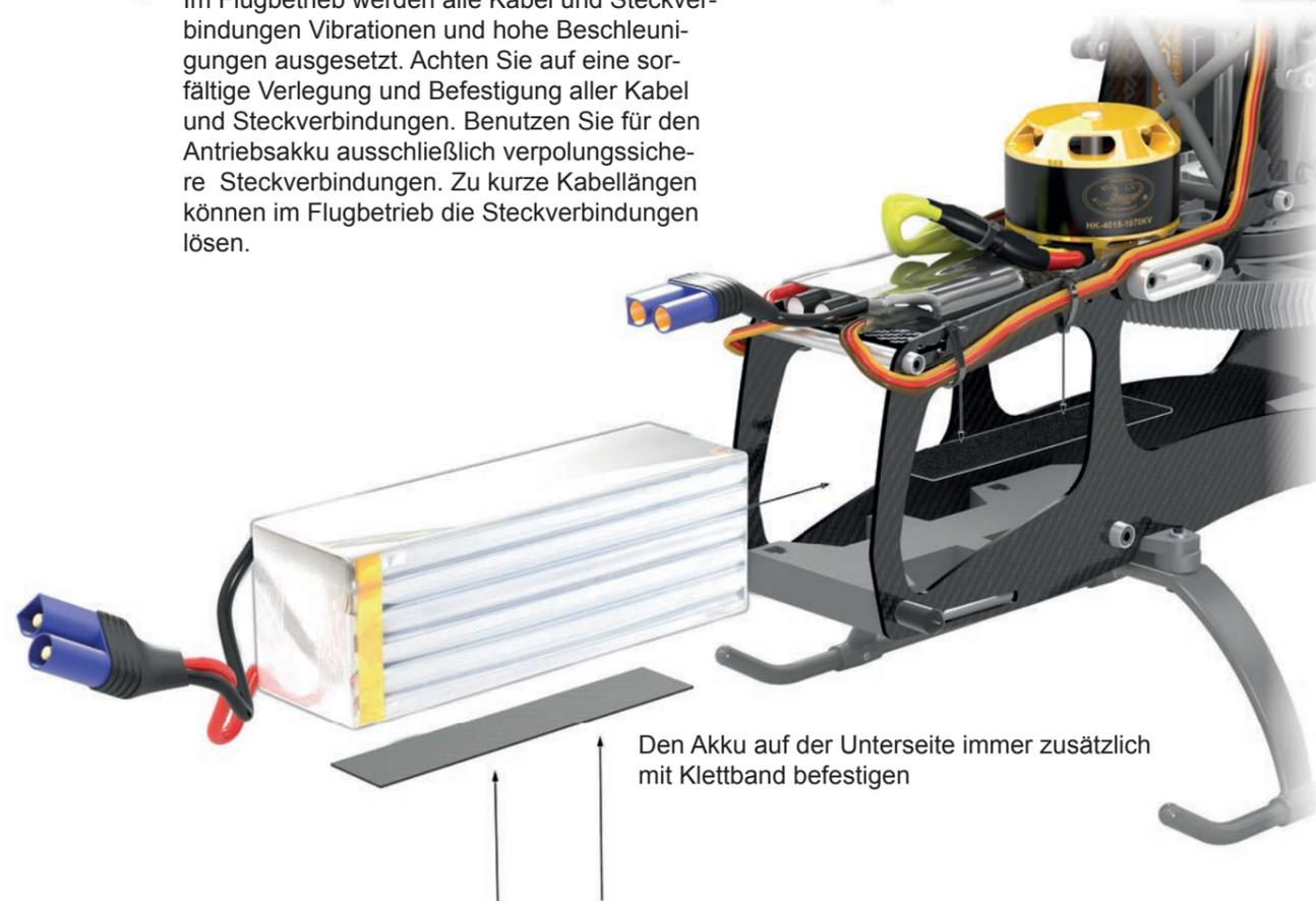
Den Akku auf der Unterseite immer zusätzlich mit Klettband befestigen
