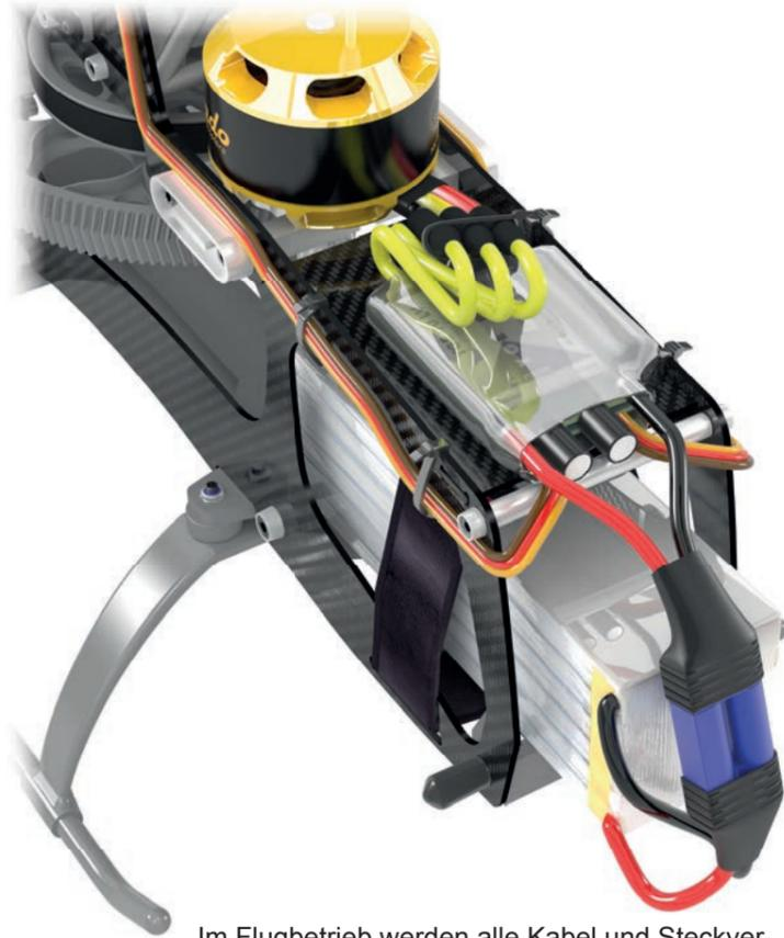
Im Flugbetrieb werden alle Kabel und Steckverbindungen Vibrationen und hohe Beschleunigungen ausgesetzt. Achten Sie auf eine sorgfältige Verlegung und Befestigung aller Kabel und Steckverbindungen. Benutzen Sie für den Antriebsakku ausschließlich verpolungssichere Steckverbindungen. Zu kurze Kabellängen können im Flugbetrieb die Steckverbindungen lösen.
