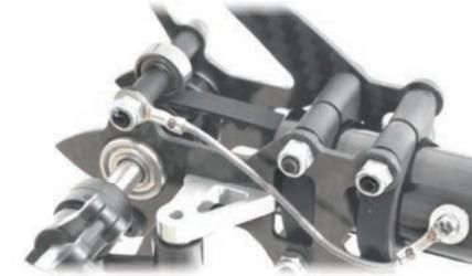
Bild 1) Verbinden Sie mit dem kurzen Kabelstück das Heckrohr und die Riemenandruckrolle.
